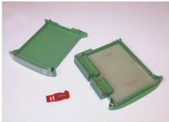
Inserimento della scheda elettronica nella base del contenitore. Insertion of the PCB into the base of the enclosure.
