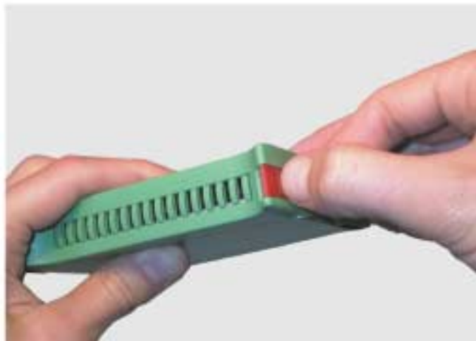
Smontaggio del gancio Nota: premere sulla base del contenitore e far scivolare il gancio fuori sede. Disassembling the hook Note: press on the base of the enclosure and make the hook slide out of its position.
