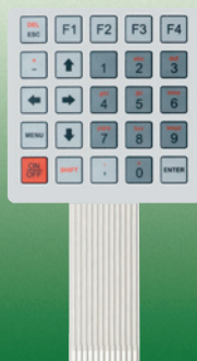
Folientastatur T25.21 , 25 Tasten, mit Druckpunkt, Rückseite mit Klebeschicht
